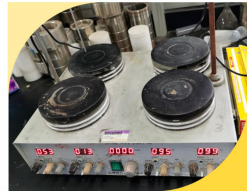
**安全风险：**小型加热设备长时间运行，可能导致设备过热，引燃周围物品，引发火灾
